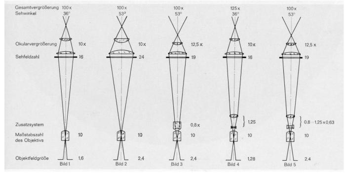
**Legend:** Gesamtvergrößerung = total magnification; Sehwinkel = visual angle; Okularvergrößerung = eyepiece magnification; Sehfeldzahl = field of view number (diameter of eyepiece diaphragm); Zusatzsystem = intermediate optics; Maßstabszahl des Objektivs = objective magnification; Objektfeldgröße = size of object field; Bild = picture.
